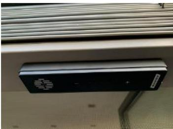
Gehäusedeckel schließen und mit den mitgelieferten acht Schrauben festschrauben. Anschließend die Plus- und Minus-Taste gleichzeitig für fünf Sekunden drücken, um den Sen Signa zu aktivieren. Die grünen LEDs leuchten nacheinander auf und es ertönt ein Signal. Solange die LEDs blinken, das Gerät in die Halteschale einklipsen.
